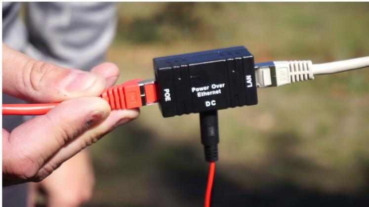
Abbildung 3: Passiver PoE Adapter
