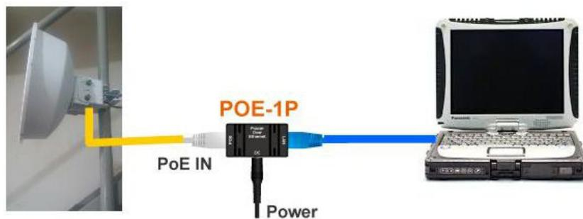
Abbildung 4: Anschluß eines Notebooks zum Einrichten der Verbindung
