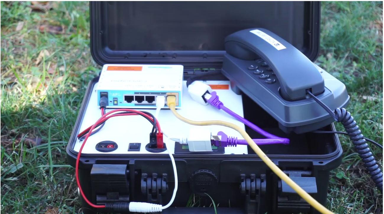
*Abbildung 12: Kofferlösung mit 8Ah Akku, WLAN-Hotspot und VoIP Telefon*
